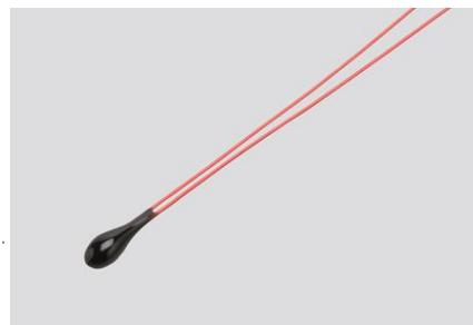
ゼロ負荷抵抗値 :  $R_{37} = 29.614 \sim 30.264\text{k}\Omega$ グループ温度公差 :  $R_{37} \pm 0.05\%/\text{グループ}$ B 定 数 :  $B_{32/41} = 3943\text{K} \pm 0.5\%$ 使用温度範囲 :  $-40^\circ\text{C} \sim 100^\circ\text{C}$
