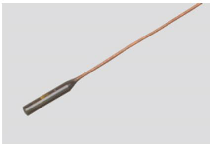
ゼロ負荷抵抗値 :  $R_{37} = 14.054\text{k}\Omega \pm 0.5\%$ B 定 数 :  $B_{0/50} = 3454\text{K} \pm 1\%$ 使用温度範囲 :  $-10^\circ\text{C} \sim 70^\circ\text{C}$
