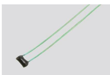
ゼロ負荷抵抗値 :  $R_{25} = 50.00\text{k}\Omega \pm 5\%$ B 定 数 :  $B_{25/85} = 3435\text{K} \pm 1\%$ 使用温度範囲 :  $-10^\circ\text{C} \sim 100^\circ\text{C}$
